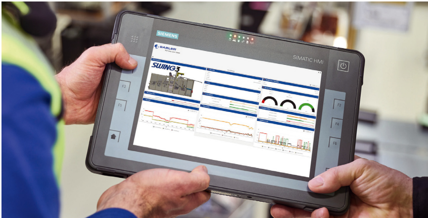
Bild 3. Tragbares Comfort Panel: Das gemeinsam mit Siemens entwickelte Gabler-Dashboard visualisiert über das offene, Cloud-basierte Softwaresystem MindSphere Maschinen- und Prozessdaten © Siemens
