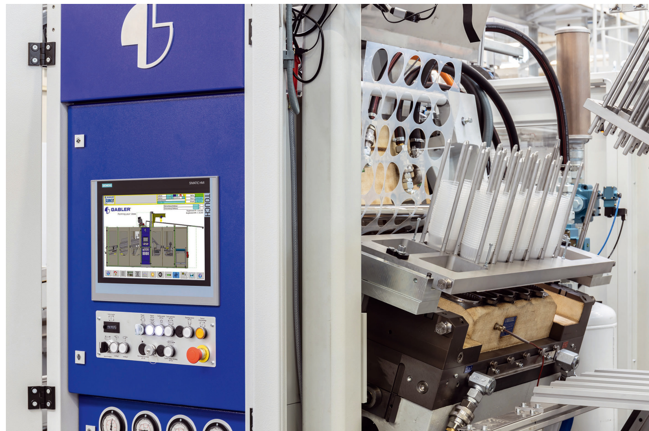
Die erweiterte Maschinenfunktionalität der neuen Thermoformanlage von Gabler Thermoform lässt sich von einem einzigen Bediener mithilfe des Simatic HMI Comfort Panels sicher beherrschen © Siemens
